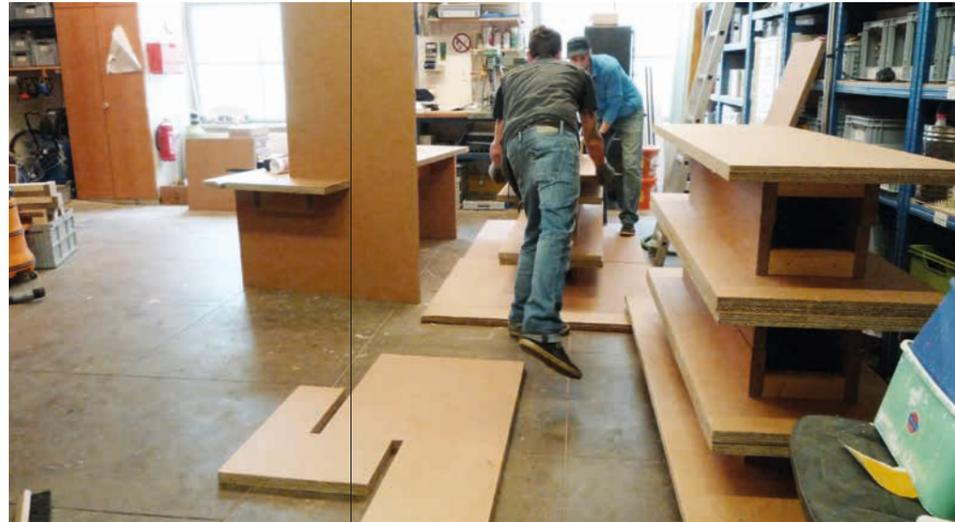
Die technische Realisierung und handwerkliche Ausführung wurde von der Grazer dp Projektform AG erledigt. Zuerst wurden Doppelwellkartons zu 4 cm starken Platten verleimt und nach Plan beschnitten.
